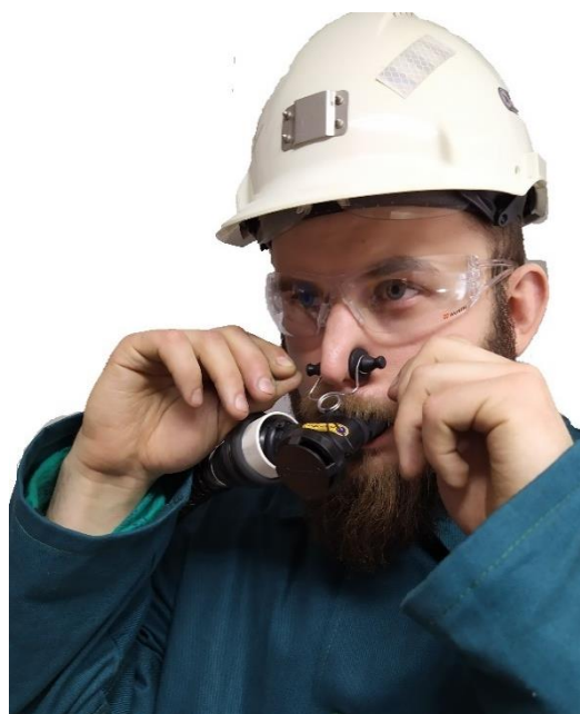
Rys. 6. Poprawnie założony aparat uciezkowy typ MANTA 50 w celu użycia
